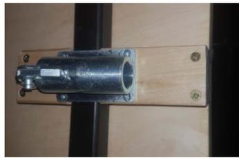
Sollte die Werkbank einen Rahmen unter der Platte aufweisen, so muss eine Zulage in der Stärke des Rahmens mit befestigt werden.
