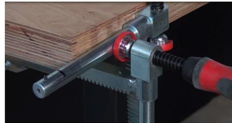
Fixbutler kann auch vertikal montiert werden, um auf der Werkplatte zu spannen. Je nach Bauart der Werkbank, müssen hierfür evtl. Aufnahmen für die Halterungen angebracht werden.
